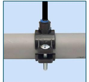
Quitar el clip azul del collarín de desagüe, introducir el extremo de la tubería hasta que sobresalga unos 3 mm. Volver a colocar el clip en su posición. Para finalizar, encajar el tubo en el orificio realizado en el desagüe, enroscar los tornillos y ajustar.
