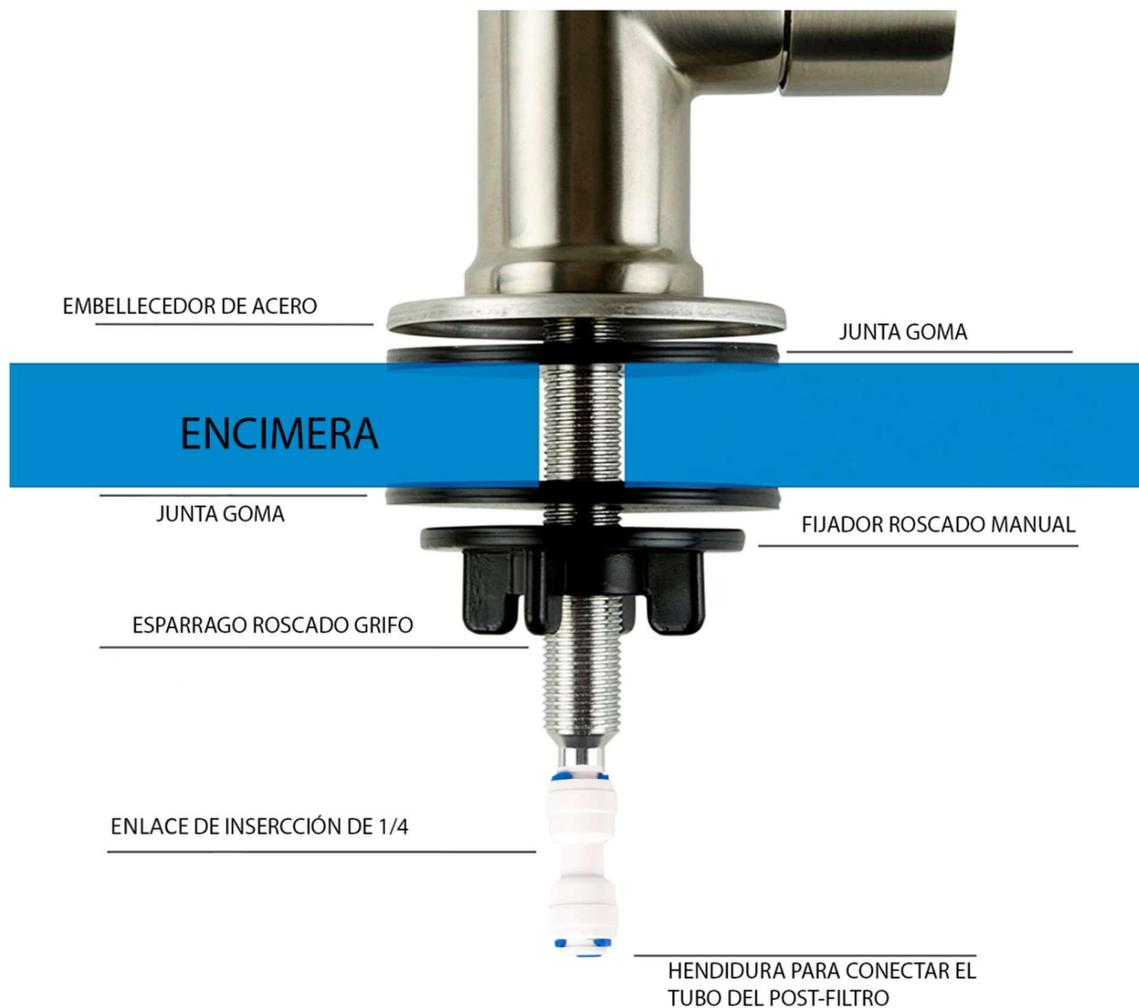
Tal y como aparece en el diagrama superior, el grifo está provisto de un fijador, el cual no necesita de herramienta para su apriete. Al esparrago de la base, se conectará el enlace suministrado y en el otro extremo del codo el tubo para conectarlo al postfiltro.
